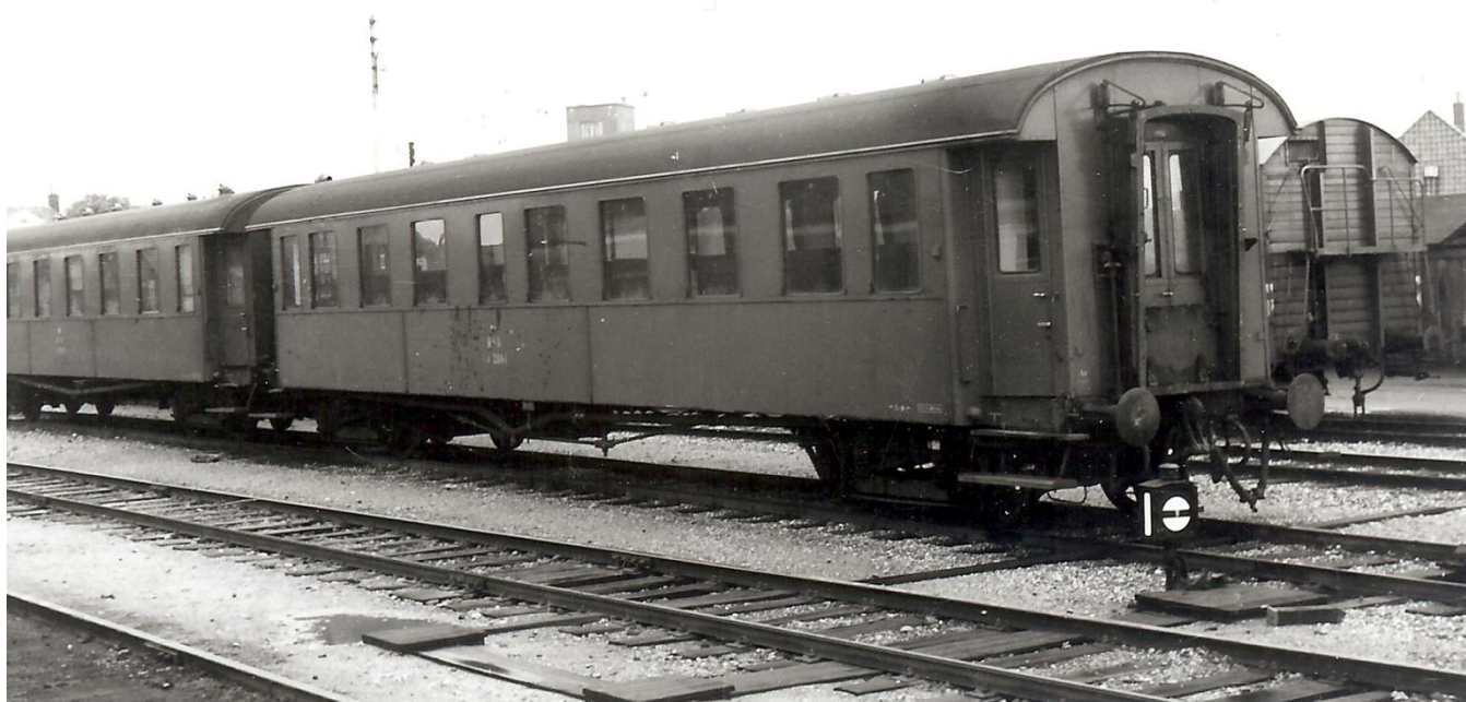
Cp 2801 i Bramming 1965, man ser tydeligt de to støtter i strækbåndet på undervognen, hvilket ikke var "normalen" for Cp vognene.
