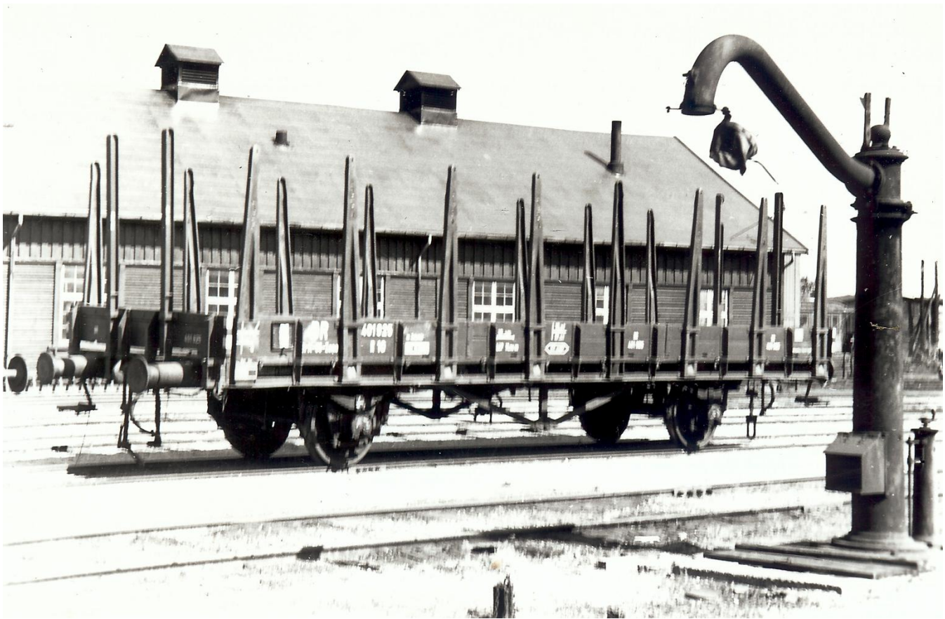
R 10. 401 925. Her moderniseret med metalsidestøtter, noget de danske Tf vogne aldrig fik – underligt nok for de var langt mere økonomiske i brug end de der var fremstillet af træ.
