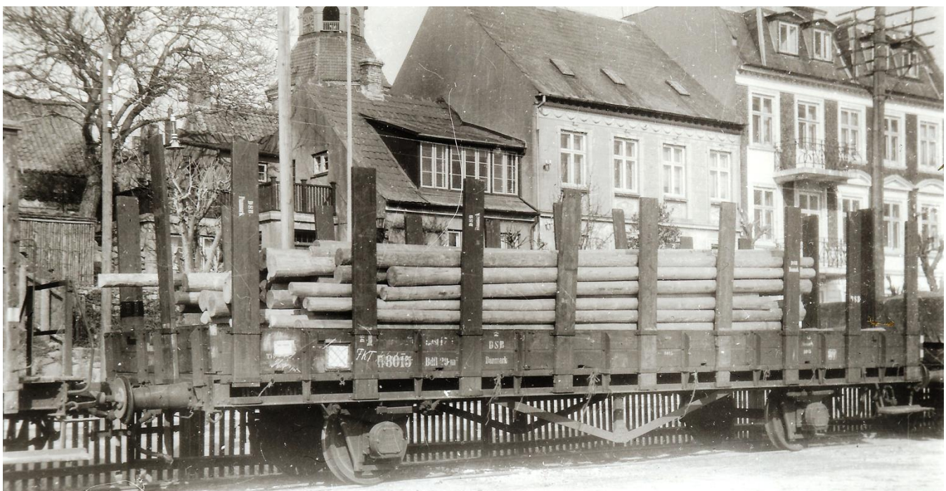
Tf 8015 i Fåborg 1957. Vognen er læsset med telefon pæle til FKT. Bemærk lige hjørnemarkeringerne for bremse udstyr, de siger at vognen er udstyret med G bremse - hvis i kan se noget bremseudstyr, så kan jeg også.
