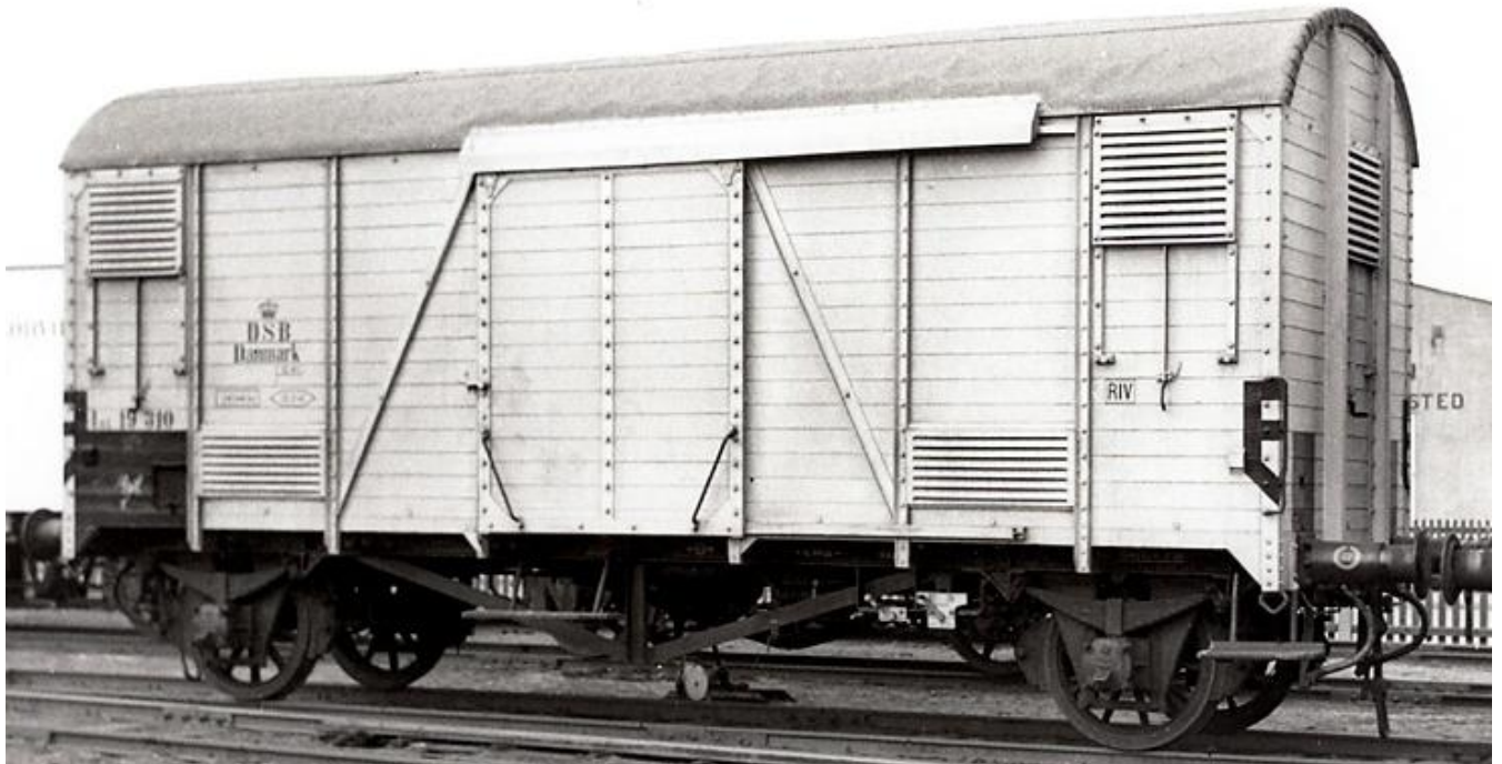
Et eksempel på IA vognene efter de blev omlitreret, her er det IAL 19 310 i Aarhus 1952. Det usædvanlige ved denne vogn er at den er udstyret med ikke mindre end to aksler med egerhjul – det er den eneste dokumentation jeg har set på fænomenet. Foto.: Poul Egon Clausen. Arkiv.: DMJK.
