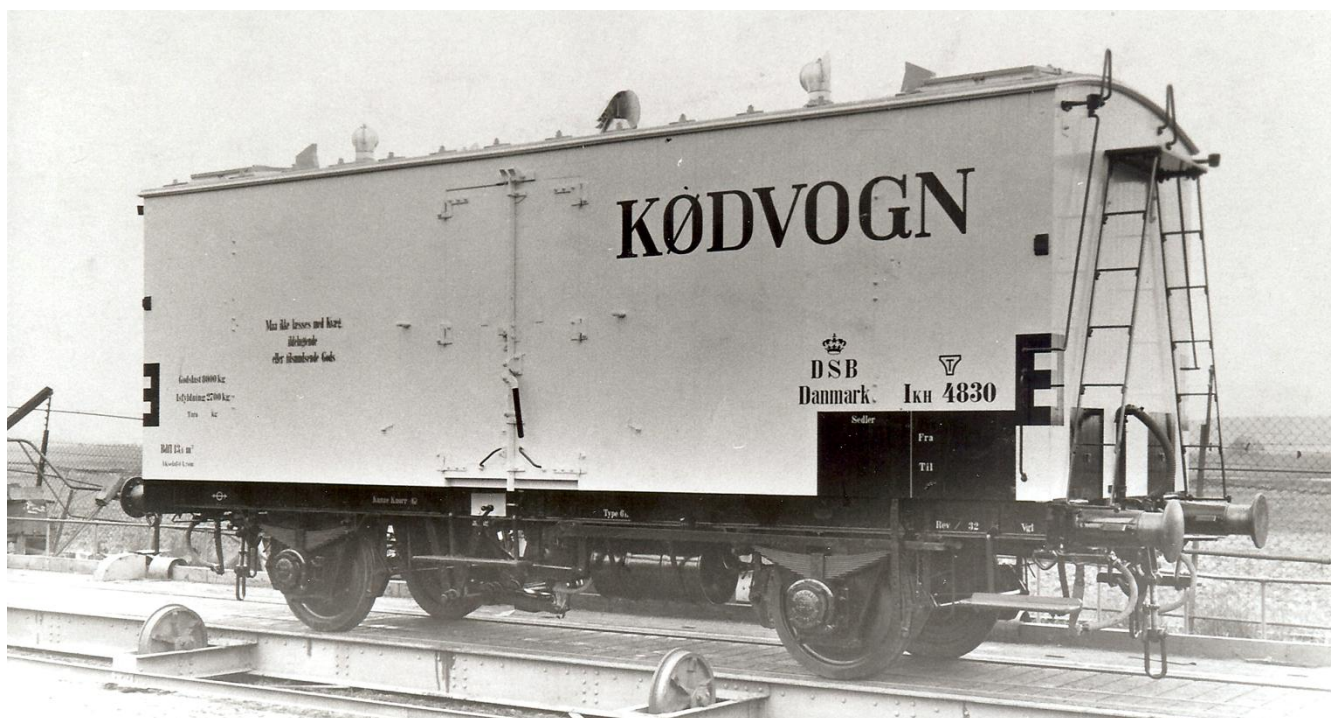
Den sidste IKH vogn der blev leveret af Scandia i 1932, IKH 4830. Ikke nogen nykonstruktion, men en moderne undervogn med en på mange måder opdateret, men også stærkt antikveret vognkasse.
