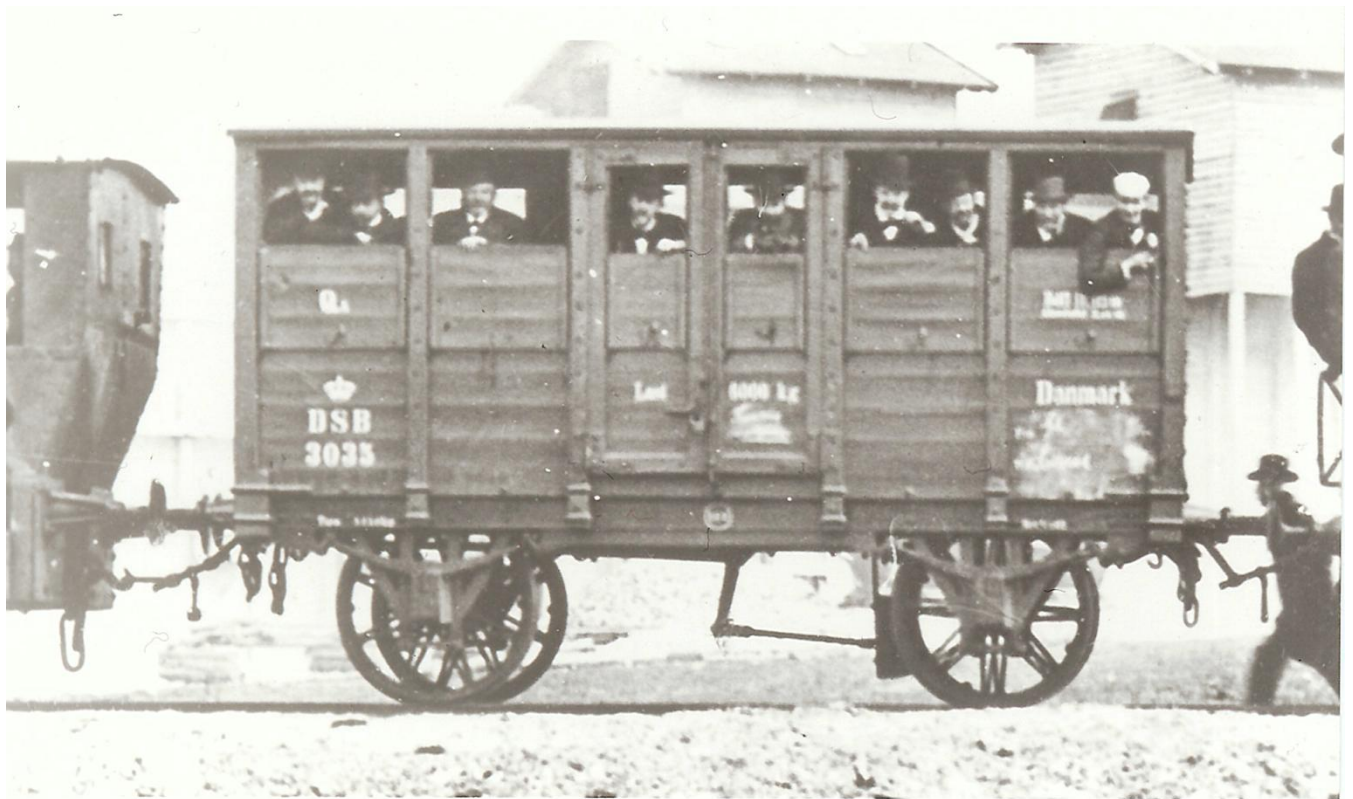
QA 3035 bygget af Scandia 1872 og udrangeret i 1918. Man kan roligt sige at vognen hørte til de tidlige typer af Q vognene, den engelske byggestil er særdeles tydelig og alligevel er det ikke svært at finde fælles træk på vognen på næste foto.
